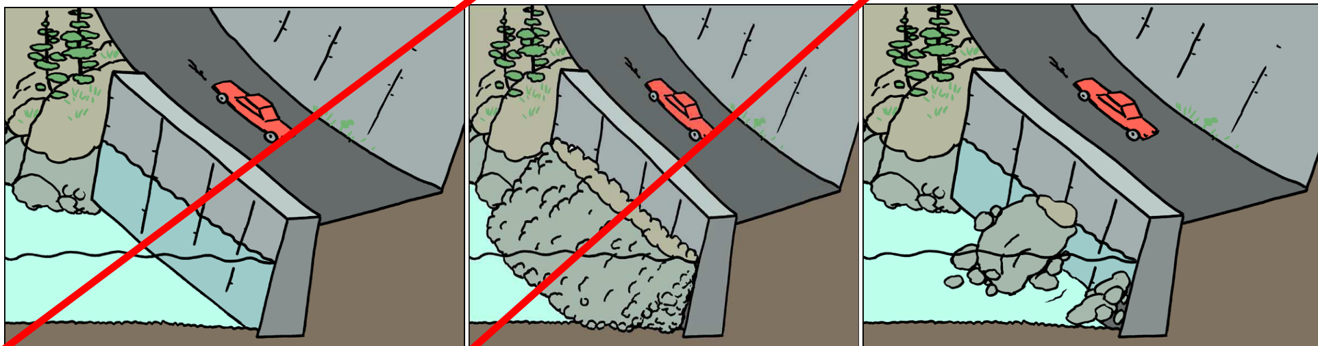
Slika 2: Predlog ureditev podpornih zidov v vodotokov
